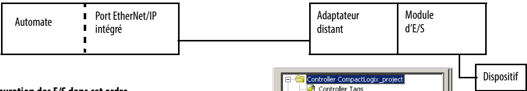
Figure 13 – Configuration des E/S distribuées en réseau EtherNet
